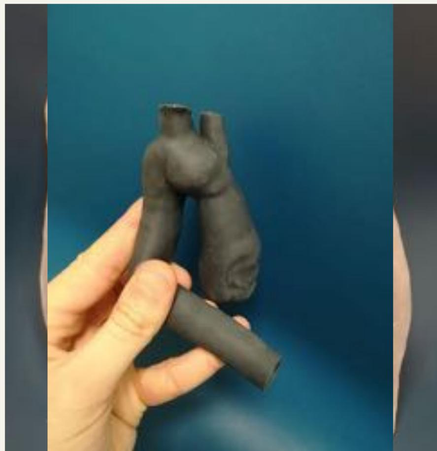
Visión anterior y posterior del modelo impreso en resina **rígida** fotopolimerizable transparente (tecnología DLP).
