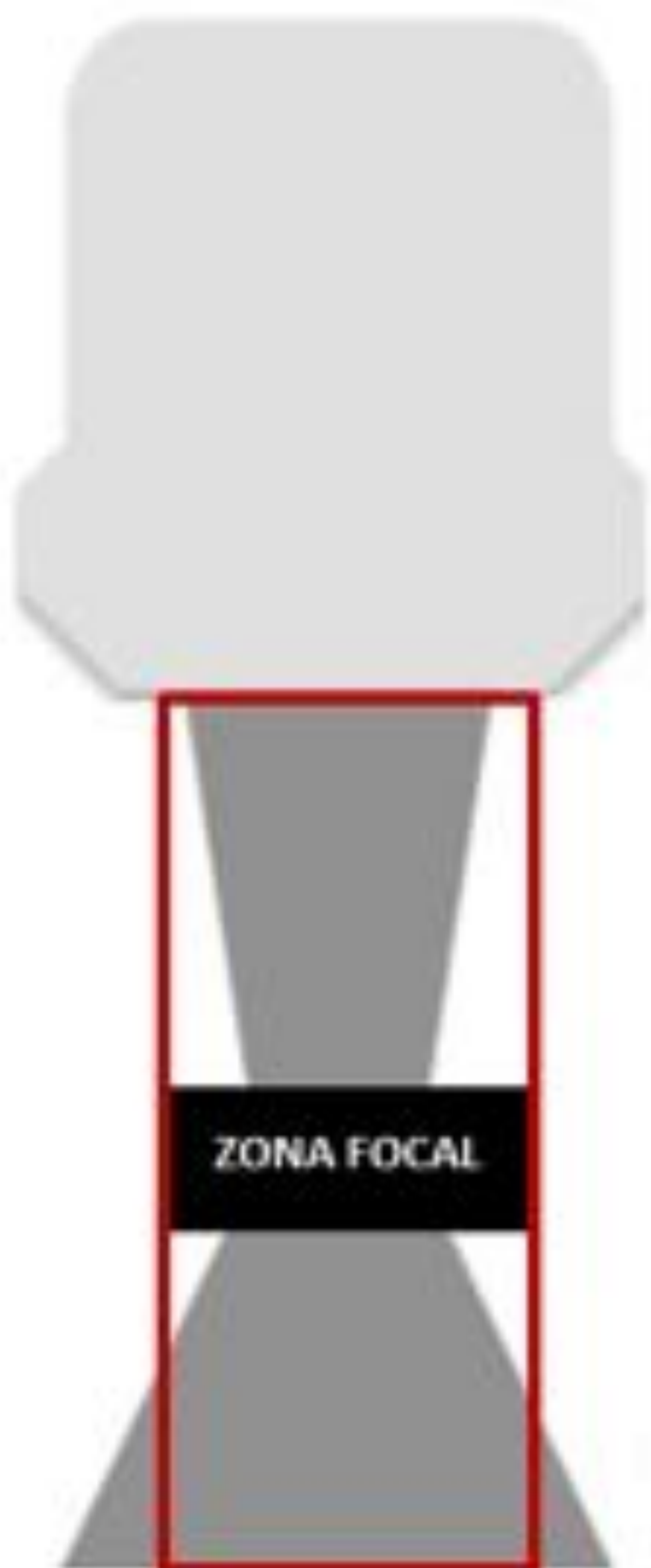
Figura 1. Diagrama de la morfología que adopta el haz principal de US en relación a la zona focal. El rectángulo rojo indica el área de recepción de ecos que el equipo de US asume.
