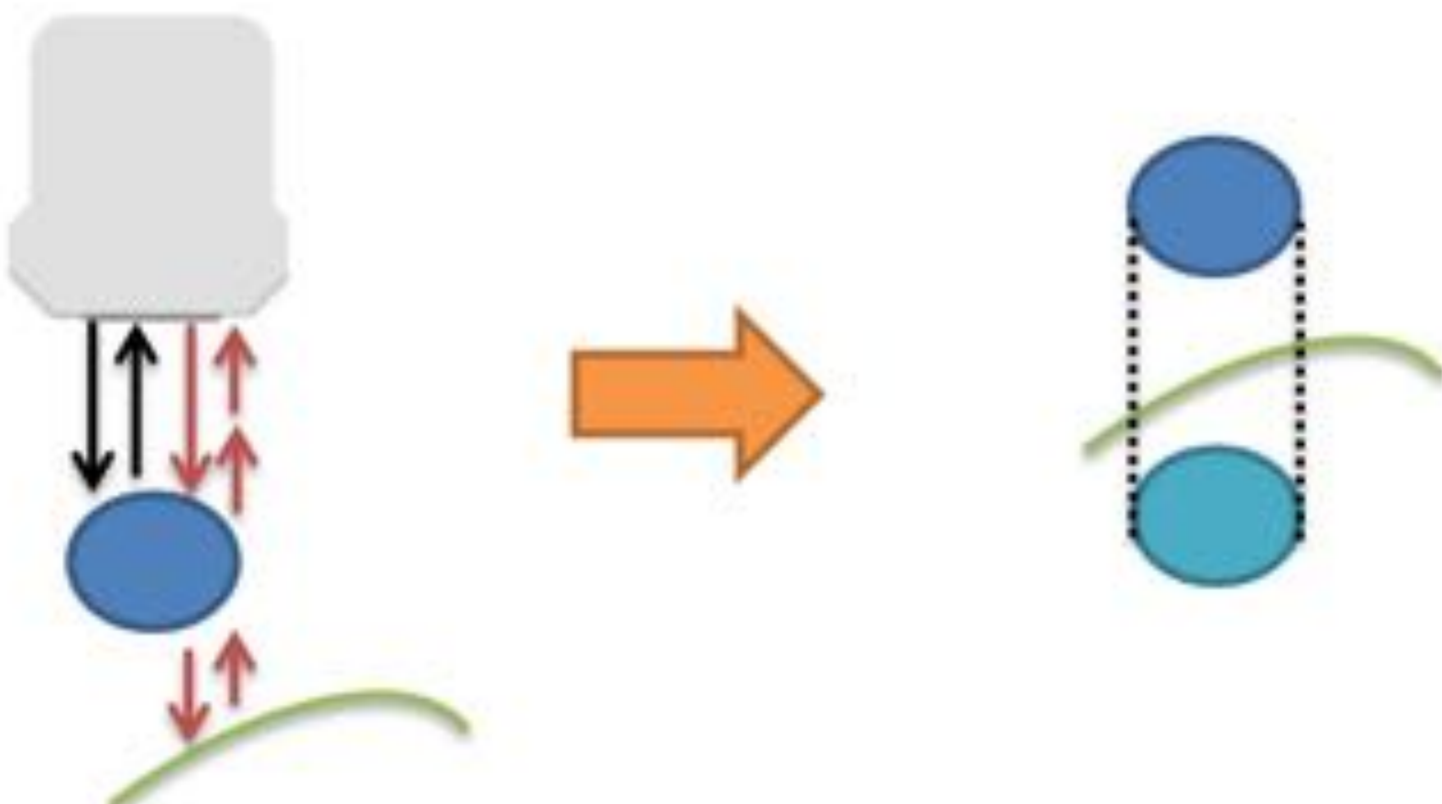
Figura 21. Representación gráfica del artefacto “en espejo”. Flechas rojas: indica el retraso de los ecos reflejados, que en la imagen de la derecha se traduce en una duplicación de la estructura en localización más profunda.
