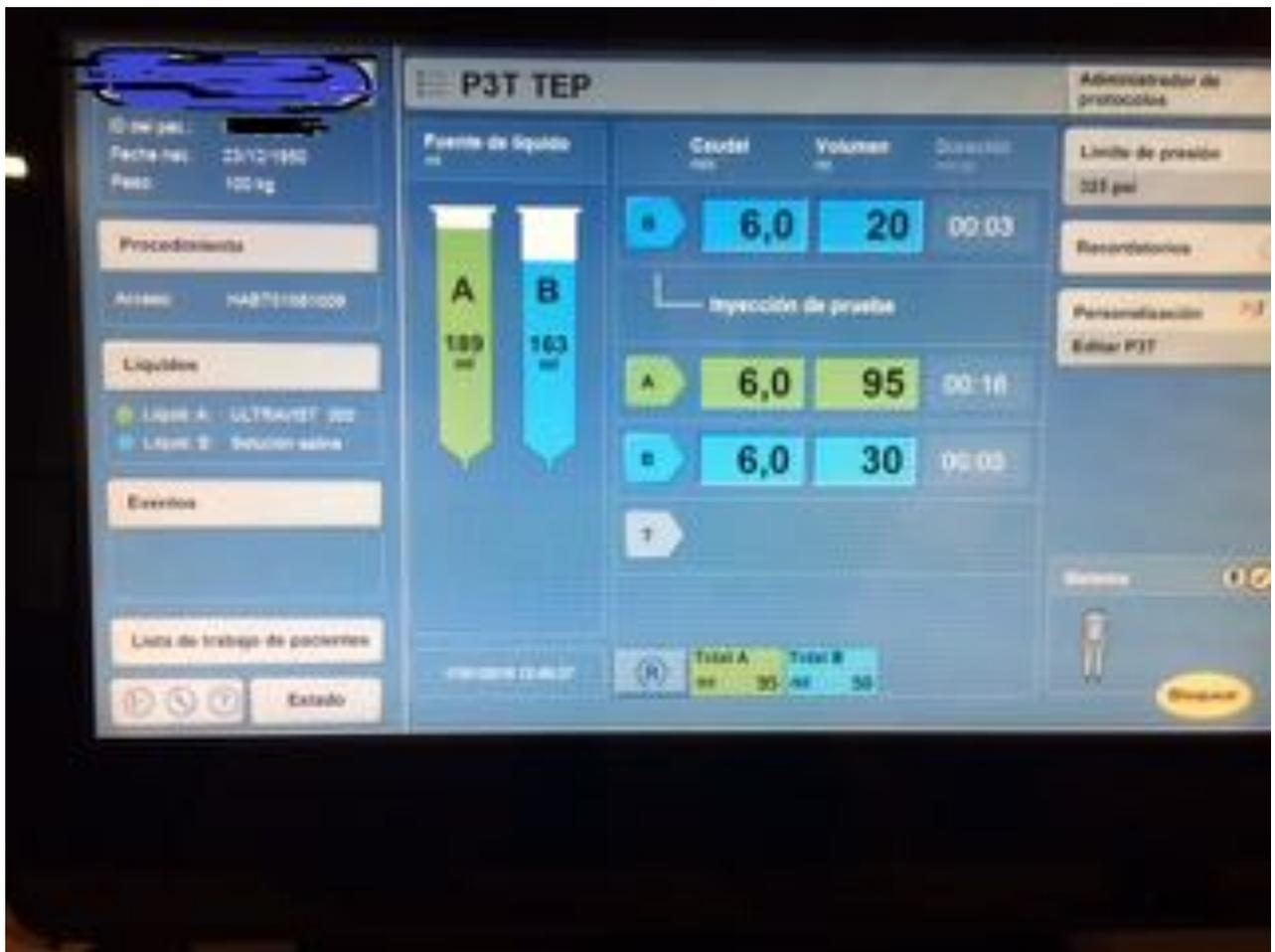
**Fig. 1:** Pantalla de la plataforma Certegra P3T que muestra un ejemplo de protocolo de inyección en un angioTC pulmonar, donde A es el contraste introducido y B el suero salino. Con una concentración de contraste de 300 el programa introduce 90 ml de contraste yodado a 6ml/sg para un paciente que pesa 100 kgs.
