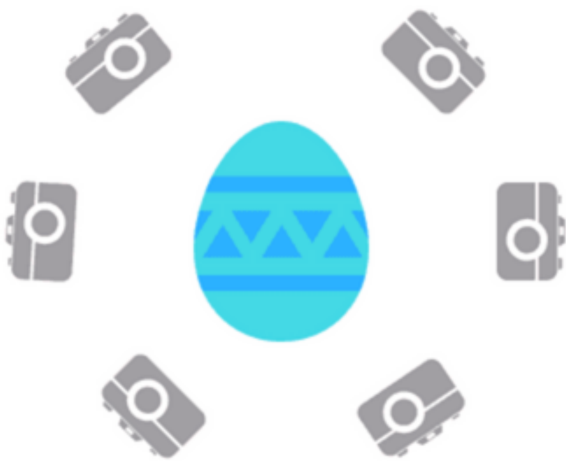
Fig. 1. Esquema de fotogrametría 3D
