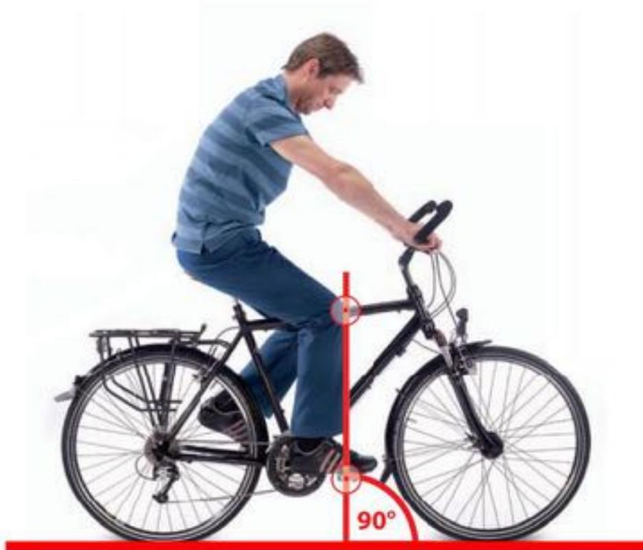
**Fig. 3:** Estando sentado el ciclista sobre el sillín y con las bielas en posición horizontal, la pierna debe formar un ángulo de  $90^\circ$  con respecto al suelo (tomando como referencia una línea imaginaria que pase por el polo anterior de la rótula y por el punto de sujeción del pie al pedal).
