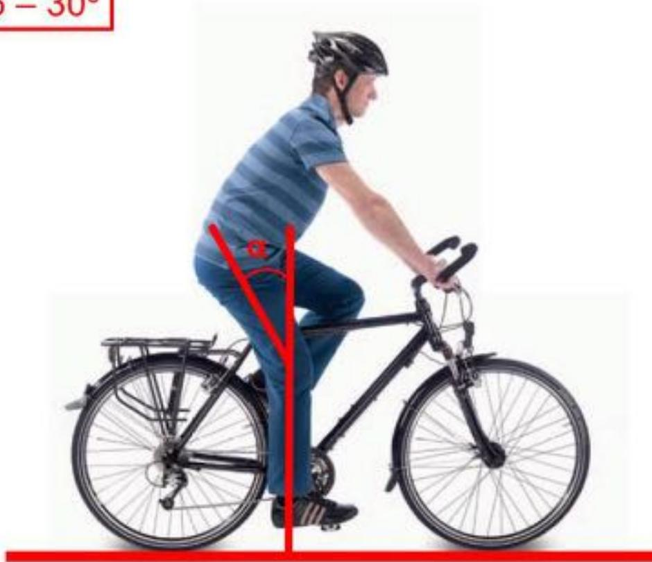
**Fig. 2:** El fémur debe de hacer un ángulo con la vertical de 25 – 30°, estando el ciclista sentado sobre el sillín y con el pedal en posición inferior.
