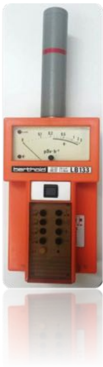
Fig. 1: Contador de radiación. Berthold LB1020
