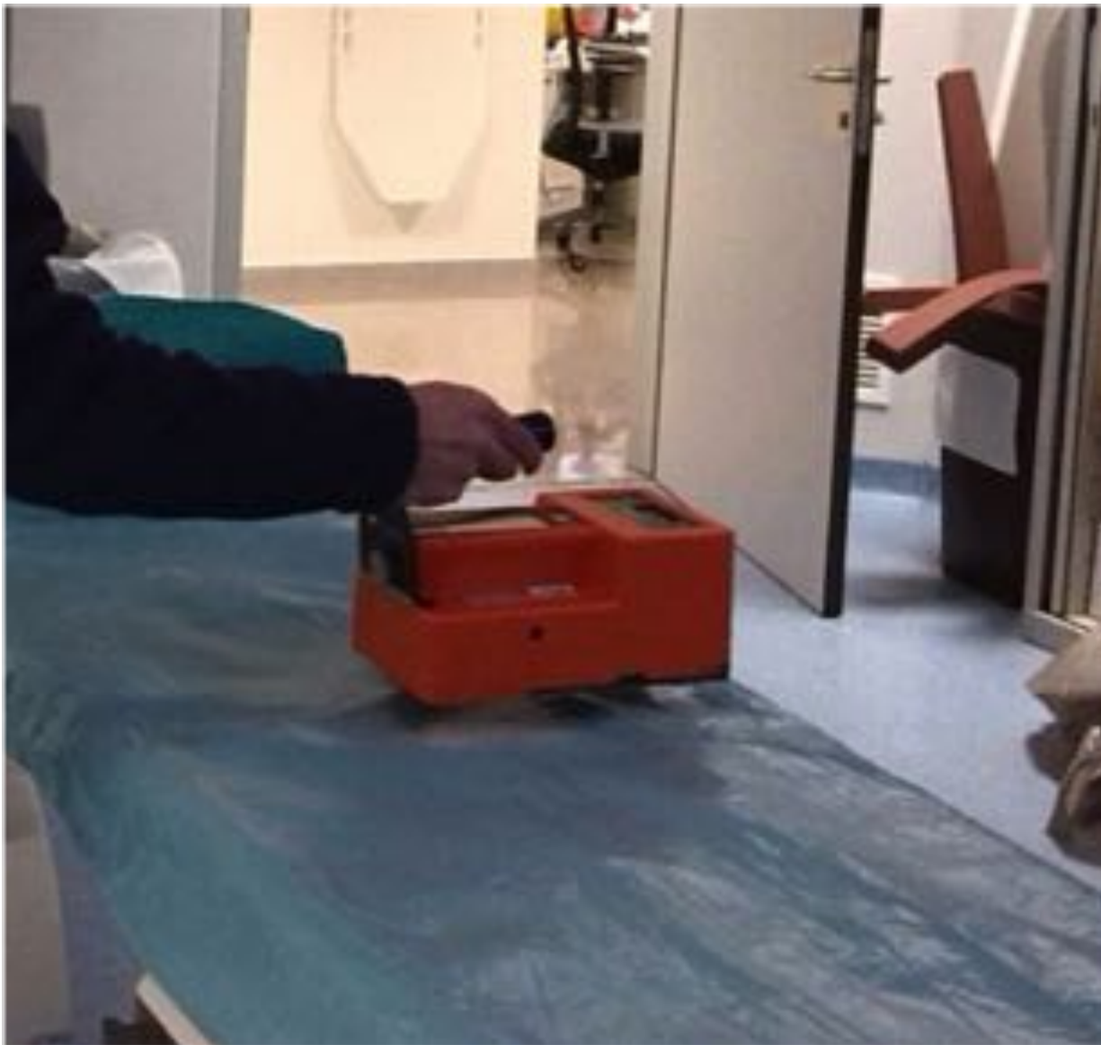
Fig. 8: Verificación de los niveles de contaminación sobre el material clínico y las dependencias utilizadas ( < 3.7 \text{ Bq/cm}^2 )
