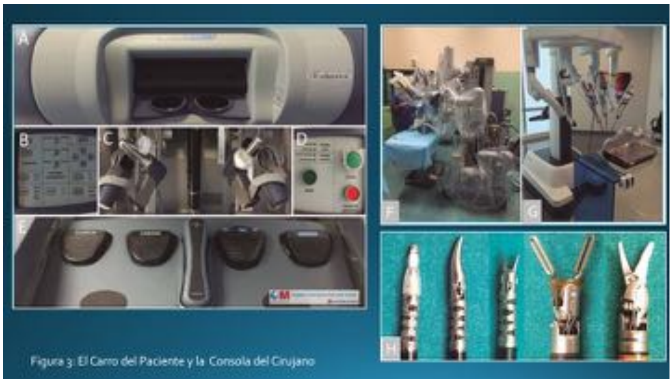
Fig. 3: A-E: Consola del Cirujano, A: Visor, B: Panel derecho, C: Manipuladores Maestros, D: Panel Izquierdo, E: Pedalera. F-H: Carro del Paciente. F y G: Carro del paciente sobre la camilla del paciente. H: Instrumentos Endowrist
