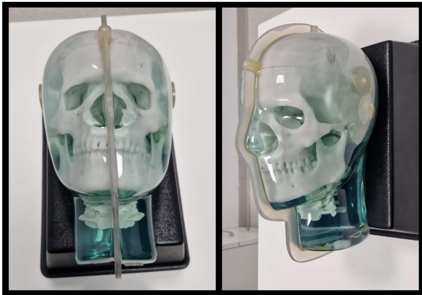
**FIGURA 4.** Fantoma utilizado para la calibración periódica de las secuencias de RM.
